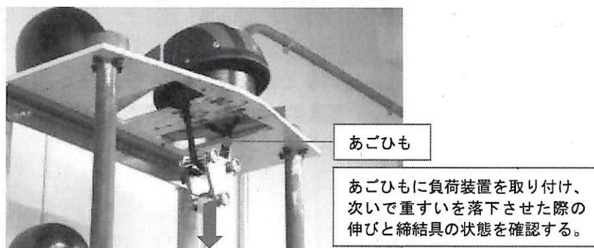
写真2. 保持装置の強さ試験の様子
