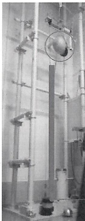
前処理したヘルメットを人頭模型に装着し、アンビルに落下させたときの衝撃加速度と継続時間を測定する。
