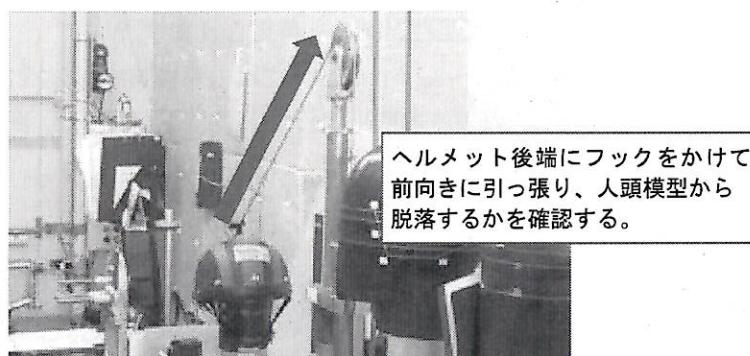
写真3. 保持装置の性能試験の様子
